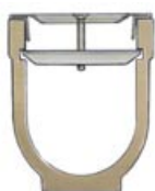
Zajištění roštu umožní jeho bezpečné upevnění
